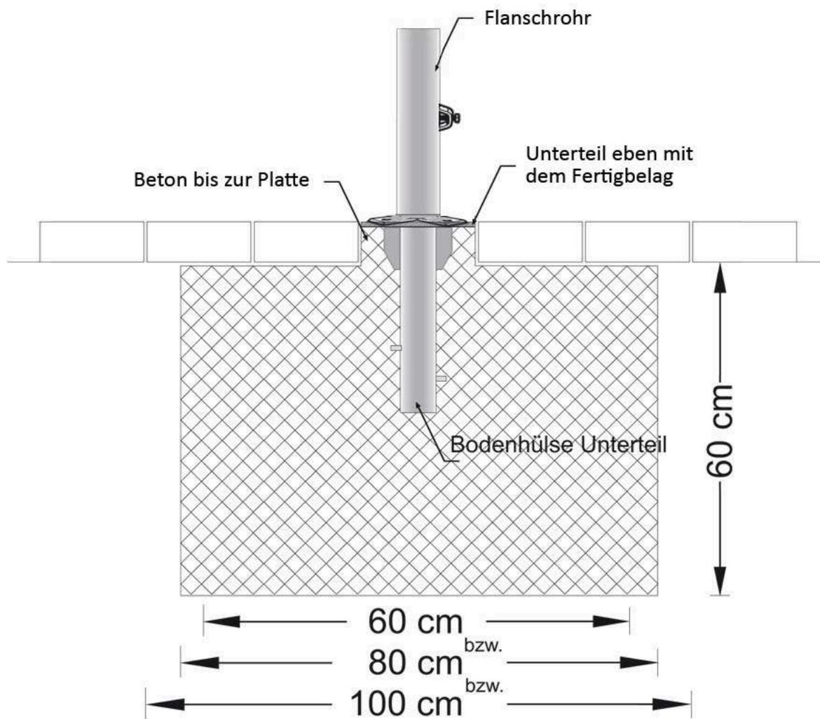
Die Abmessungen des Fundaments dürfen die unten angegebenen Abmessungen nicht unterschreiten. Das Unterteil der 2-teiligen Bodenhülse soll bündig mit dem Fertigbelag abschließen und vom Beton bis zur Platte gestützt werden.
